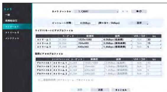
カメラの監視/録画映像の解像度や圧縮方式、画質、伝送速度、フレーム数を設定することができます。
