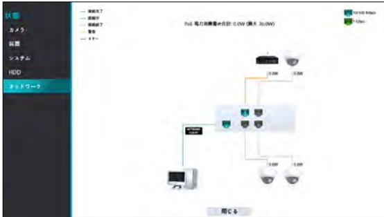
表示される情報は、カメラ接続の有無、LANポートリンクの状態、電力使用量、接続されているクライアントの台数、ネットワーク情報の詳細な説明は次のとおりです。
