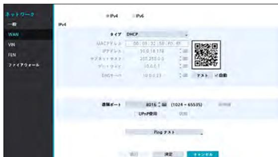
**DHCP**を選択して**適用**を押すと、DHCPサーバーからIPアドレスなどのネットワーク情報を自動的に割り当てられます。ネットワーク情報が割り当てられると、IPアドレス項目にNVRの現在のIPアドレスが表示されます。
