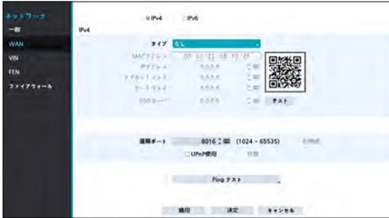
種類をなしに選択して保存すると、IPv4を使用しないように設定されます。
