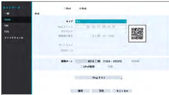
種類をなしに選択して保存すると、IPv6を使用しないように設定されます。
