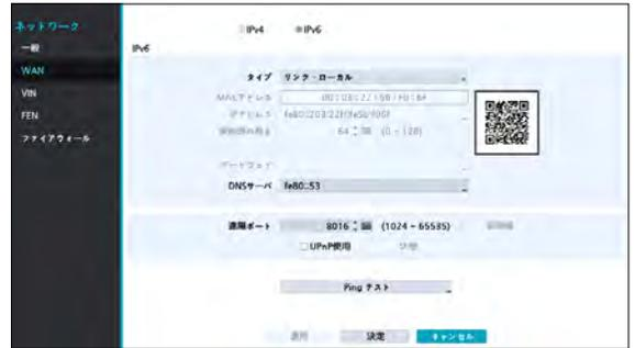
**タイプ**をリンク-ローカルに選択してください。リンクローカルアドレスは、同じリンクの隣接ノードと通信するとき 사용됩니다。
