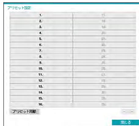
PTZモードでリモコンのプリセットビューボタンを押してプリセット移動設定ウィンドウが表示されたら、プリセット番号を選択して、その番号に保存された位置にPTZカメラをすぐに移動させることができます。
