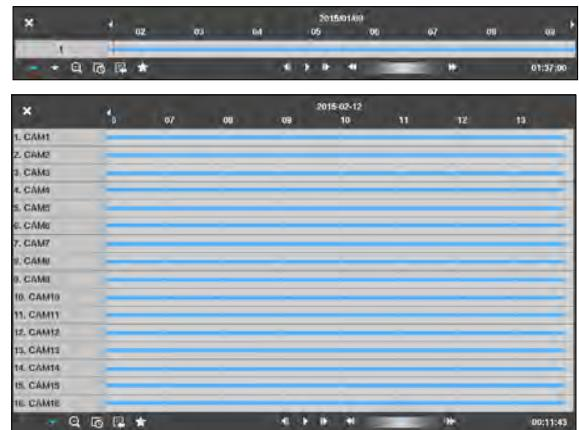
検索ウィンドウ上段に録画された日付/時間情報が表示されます。録画テーブルの縦の線は現在の再生位置を表します。リモコンの方向ボタンを利用して、現在の再生位置を区間単位で移動することができます。マウスで再生位置を自由に移動させることができます。
