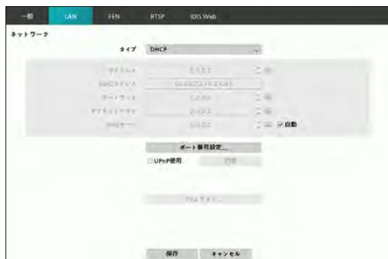
**DHCP**を選択して**保存**を押すと、DHCPサーバーからIPアドレスなどのネットワーク情報を自動的に割り当てられます。ネットワーク情報が割り当てられると、IPアドレス項目にDVRの現在のIPアドレスが表示されます。
