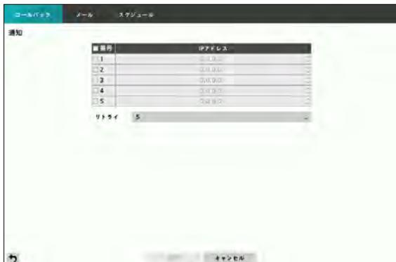
コールバックを受信するサーバーのIPアドレスを設定し、DVRが遠隔接続に失敗したとき、リトライする回数を1回から10回まで選択することができます。
