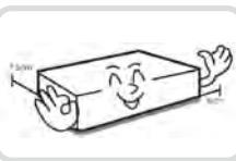
本機の後面には接続のための端子が突出しているため、壁に近すぎるところに設置するとケーブルが無理に曲がったり押さえつけられたりして破損する恐れがあります。壁から15cm以上の間隔を開けて設置してください。
