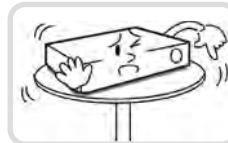
水平で安定した場所に設置し、垂直に立てたり斜めに置いて使用しないでください。
