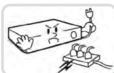
本機が作動するための電源電圧は、電圧の変動範囲が規程電圧の10%以内である必要があります。電源コンセントは必ず接地するようにしてください。電源コードを接続するコンセントには、ヘアドライヤーやアイロン、冷蔵庫などの電熱器具と一緒に使用しないでください。
