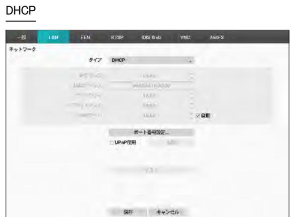
DHCPを選択して**適用**を押すと、DHCPサーバーからIPアドレスなどのネットワーク情報を自動的に割り当てられます。ネットワーク情報が割り当てられると、IPアドレス項目にDVRの現在のIPアドレスが表示されます。
