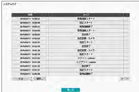
システムログ画面で、**エクスポート…**を選択するとUSBに接続している保存デバイスに**ファイル名**項目から入力したファイル名でログ情報を保存します。NetFS機能を使用中の場合(ネットワーク>NetFS)登録されたFTPサイトにログ情報をアップロードすることができます。**エクスポート**を選択します。**USB保存デバイス**または**NetFS**を選択します。NetFSを選択すると、登録されてるFTPサイトリストからFTPサイトを選択します。
