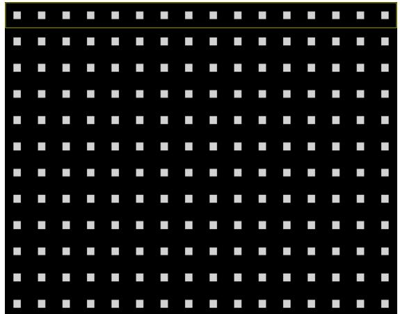
エリア設定画面でリモコンの方向ボタンを利用し、ブロック単位のエリア選択ウィンドウを上下左右に移動することができます。選択ウィンドウは16つのブロックの大きさの1列に該当し、**カメラ**ボタンで各ブロックを選択／解除することができます。マウスを利用してエリアをドラッグしたあと、選択／解除／反転させることができます。
