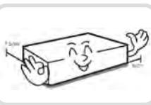
本機の後面には接続のための端子が突出しているため、壁に近すぎるところに設置するとケーブルが無理に曲がったり押さえつけられたりして破損する恐れがあります。壁から15cm以上の間隔を開けて設置してください。
