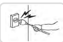
電源ケーブル部分を無理に引き抜いたり、濡れた手で電源プラグに触らないでください。コンセントがゆるい場合は電源プラグを差し込まないでください。
