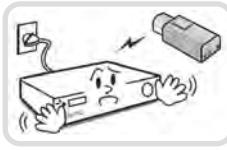
カメラの新規設置および追加工事の前には必ず本機の電源をOFFにし、製品の駆動中には絶対に信号ラインを接続しないでください。
