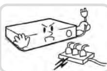
本機が作動するための電源電圧は、電圧の変動範囲が規程電圧の10%以内である必要があります。電源コンセントは必ず接地するようにしてください。電源ケーブルを接続するコンセントには、ヘアドライヤーやアイロン、冷蔵庫などの電熱器具と一緒に使用しないでください。
