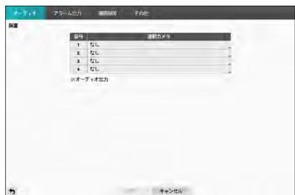
接続カメラを設定しオーディオ出力を選択すると接続カメラの録画時に当該チャンネルオーディオを同時に録音されます。
