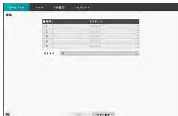
コールバックを受信するサーバーのIPアドレスを設定し、DVRが遠隔接続に失敗したとき、**リトライ**する回数を1回から10回まで選択することができます。
