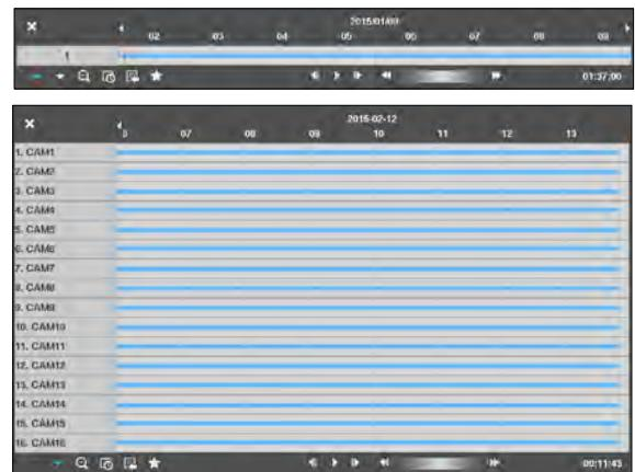
検索ウィンドウ上段に録画された日付/時間情報が表示されます。録画テーブルの縦の線は現在の再生位置を表します。リモコンの方向ボタンを利用し、現在の再生位置を区間単位で移動することができます。マウスで再生位置を自由に移動させることができます。
