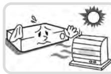
直射光線の当たらない涼しい場所に設置し、適正な温度を維持してください。ロウソクや暖房器具など、熱を発する機器の近くには設置しないでください。
