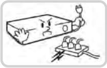
本機が動作するための電源電圧は、電圧の変動範囲が規程電圧の±10%以内である必要があります。電源コンセントは必ず接地してください。電源ケーブルを接続するコンセントには、ヘアドライヤーやアイロン、冷蔵庫などの消費電力の大きな器具を一緒に使用しないでください。
