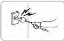
電源ケーブル部分を無理に引き抜いたり、濡れた手で電源プラグに触らないでください。コンセントがゆるい場合は電源プラグを差し込まないでください。
