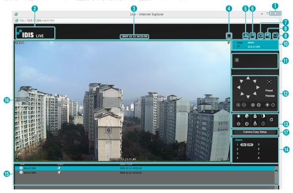
0 図 を押すと IDIS Webのプログラムが終了されます。 2 マウスのポインタをIDISロゴ部分に置けばIDIS Webのバージョンを確認することができます。 3 現在の時間情報を表示します。 ■を押すと映像を全体画面で見ることができます。キーボードのESCキーを押すと元の画面に戻ります。 4 ■を押すと現在見ている映像をPCに接続されているプリンターで印刷します。 6 ■ を押すと現在見ている映像をイメージファイルで保存します。 6 ■ を押すとディスプレイモード及びOSDの表示を設定することができます。ディスプレイモードを選択 して映像を出力するスピードを調整することができ、OSD表示リストより画面に表示するOSD情報を選 7 択することができます。 8 ■ を押すと画面を表示してカメラの設定を変更できます。 9 ■ を押すとウェブ監視モードに切り替わります。 ログイン情報を表示します。 1 1 カメラ番号を表示します。 1 遠隔地のPTZを制御します。
