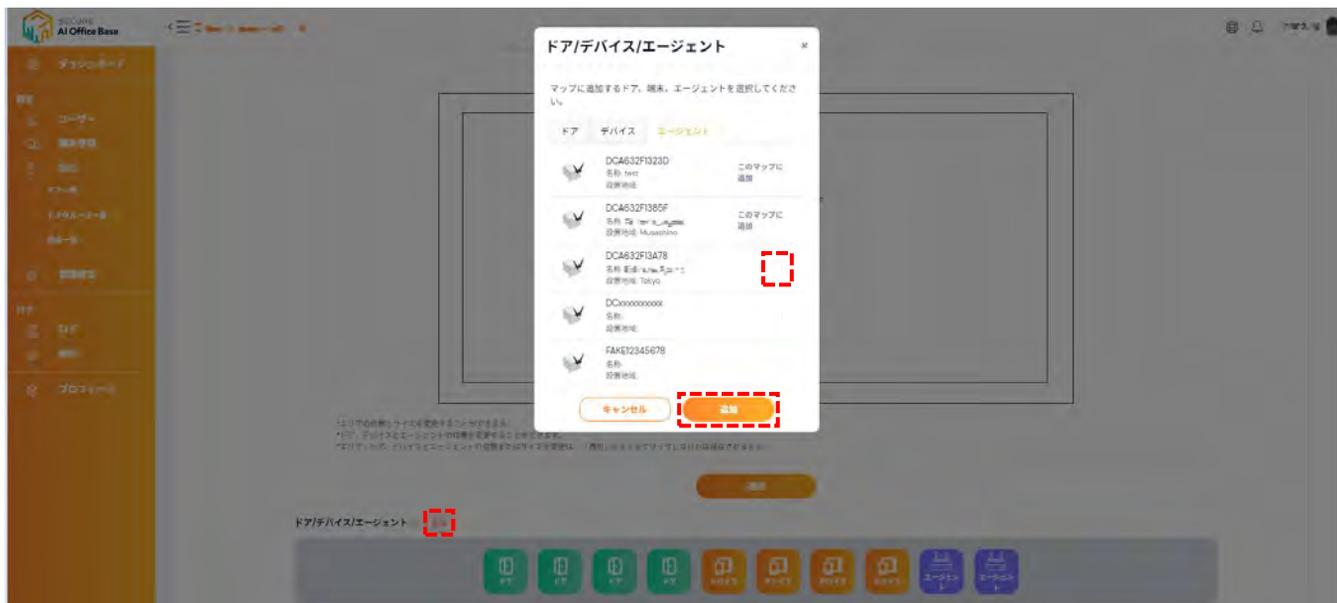
ドア・デバイス・エージェントを追加すると各アイコンが表示されます。ドラッグ&ドロップでマップ上の任意の場所に配置することが可能です。アイコンの配置が完了したら [適用] をクリックします。
